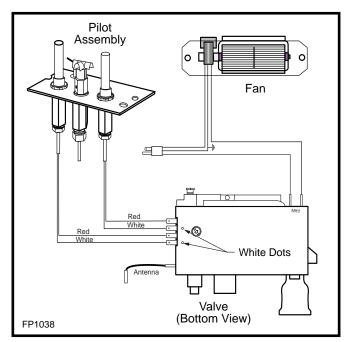
Fig. 55 Comfort Valve wiring diagram.
